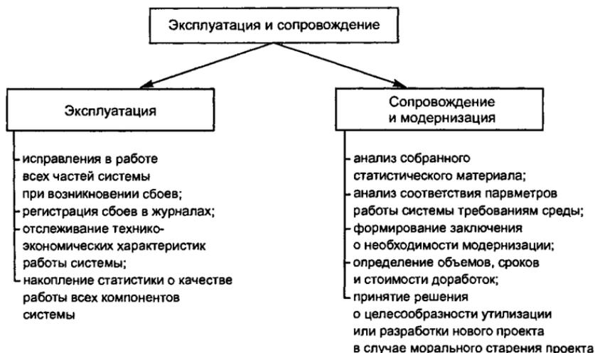
Рис. 8.4. Работы, выполняемые на стадии эксплуатации и сопровождения
